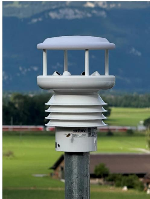
Die CLIMA Sensor US Wetterstation ist mit Ultraschall-Windmessung ausgestattet. Diese Technologie ist besonders vorteilhaft, da sie keine beweglichen Teile enthält. Darüber hinaus verfügt die Wetterstation über Radartechnik zur Niederschlagsmessung.
